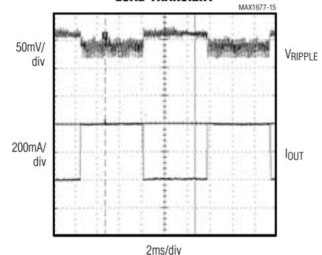
V<sub>IN</sub> = 2.4V, V<sub>OUT</sub> = 3.3V
